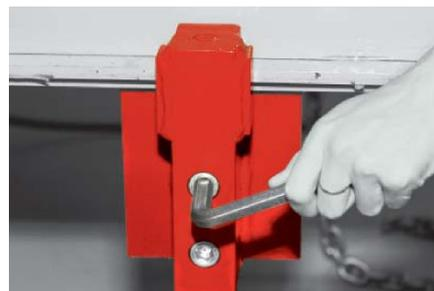
Снимите фиксирующую пружины пластину.
