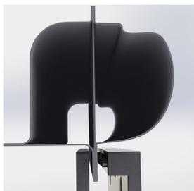
**Правильное** положение отбортовки: порог не лежит на губочных захватах, отбортовка максимально опущена между губочными захватами.
