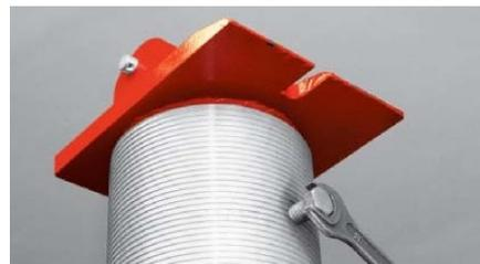
Уложите цепь в элементах силовых устройств, зафиксировав свободный конец в пазу пластины подъемной части силового устройства (фото 7). Проверьте, не перекручена ли цепь.
