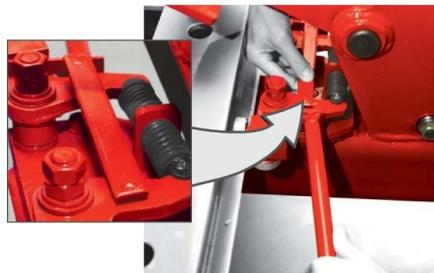
Зафиксируйте направляющий блок на силовом устройстве стопорным болтом в среднем положении.
