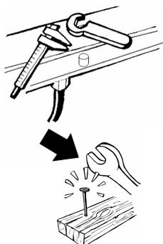
Рабочий инструмент и материалы не должны располагаться на оборудовании (или в местах, где они могут мешать механическим движениям) или в местах, где они могут упасть и, следовательно, привести к авариям.
