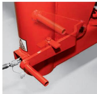
При приложении усилия на цепь во время вытяжки нижняя часть силового устройства поднимается вверх, прижимаясь к платформе.
