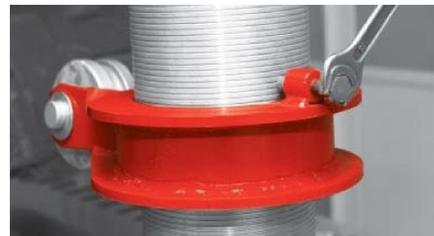
Удалите транспортировочный болт сверху силового устройства.
