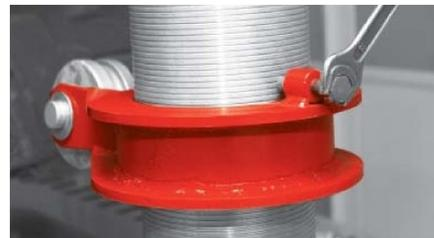
Удалите транспортировочный болт сверху силового устройства.
